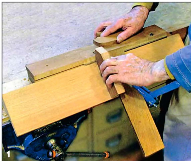
Пропиливание пазов в кромках деталей, соединяемых «на ус».
