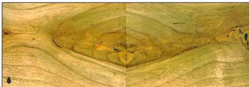
Крышка коробки собрана из двух вишнёвых дощечек. Пазы в торцах деталей для соединения встык на шпонке пропилены той же пилой, но вместо наклонной направляющей здесь использовали обычную строганую доску.
